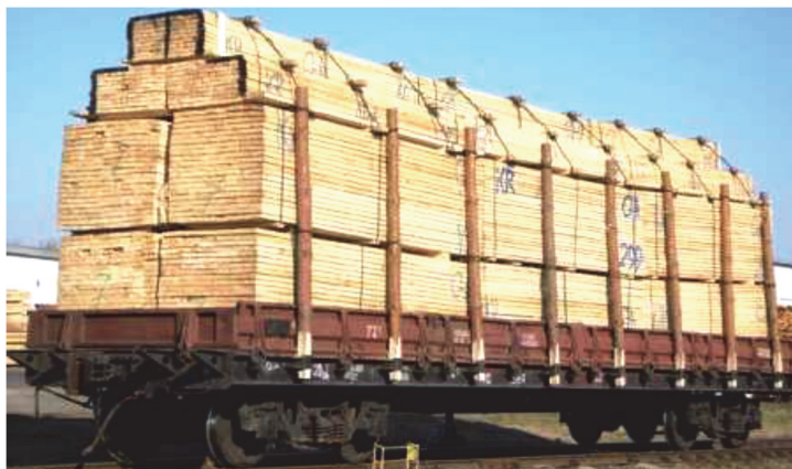
Рис. 1.9. Специализированный подвижной состав для перевозки пиломатериалов
