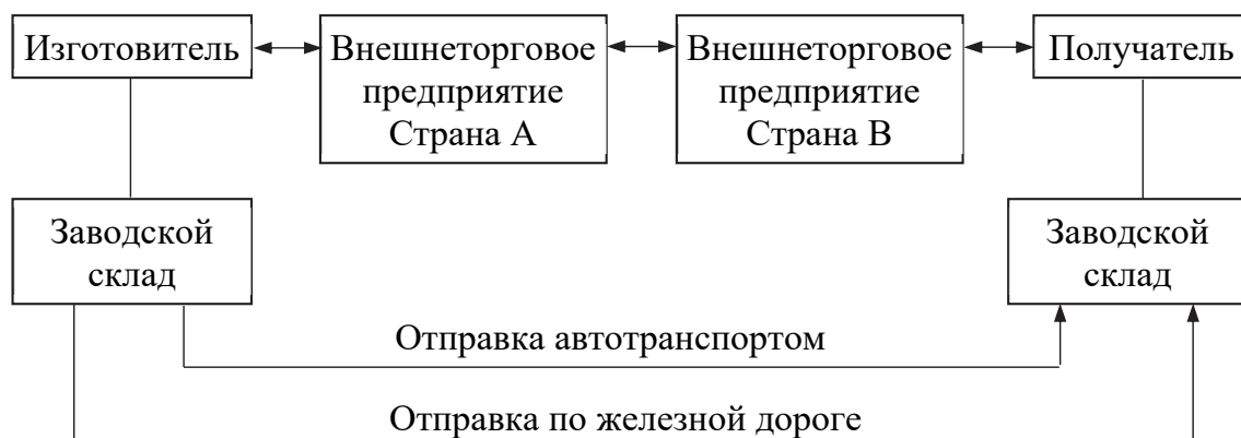
Рис. 1.11. Схема поставки лесопродукции на экспорт одним видом транспорта (автотранспортом или по железной дороге)
