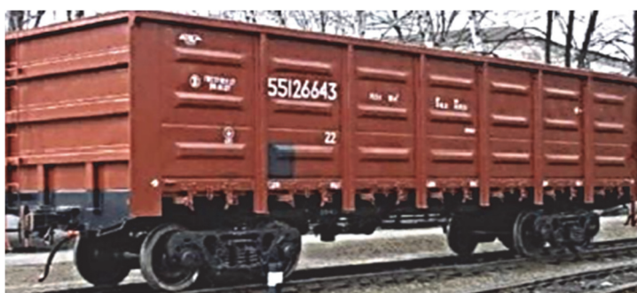
Рис. 1.10. Открытый подвижной состав для перевозки лесопродукции
