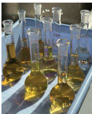
Рисунок 2 – Подготовленные растворы образца сока для последующего атомно-абсорбционного анализа
