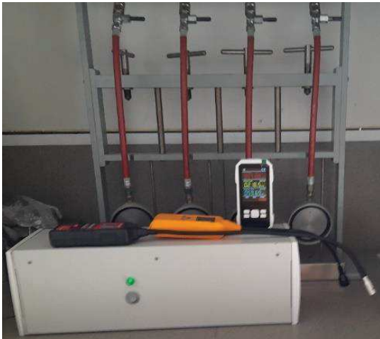
Рисунок 2 – Экспериментальная установка озонатора для обработки нефтепродуктов
