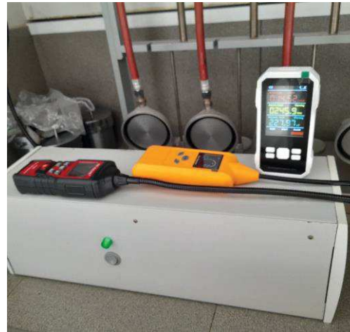
Рисунок 3 – Экспериментальная установка озонатор и приборы для измерений концентрации вредных веществ
