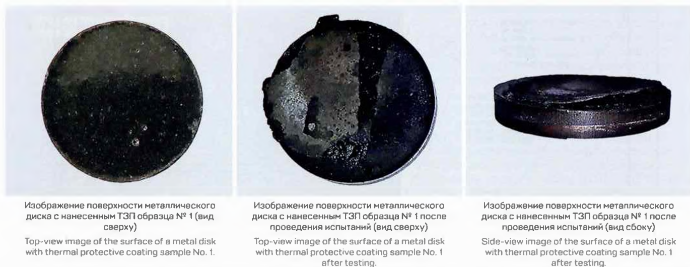
Рис. 8. Испытание ТЗП образца № 1 на основе смолы диглицидилового эфира бисфенола А/Ф с отвердителем ТЭТА
