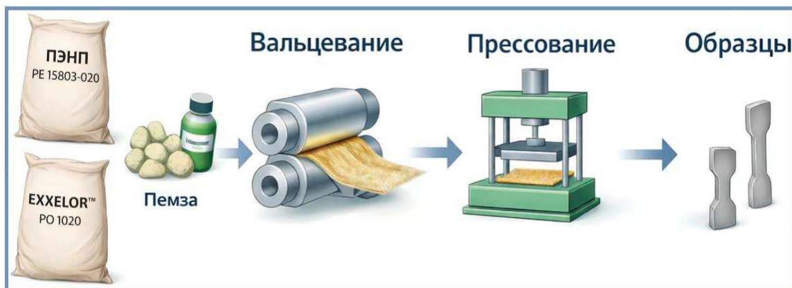
Рисунок 1 – Схематическое изображение получения полиэтиленовых композитов, наполненных вулканической пемзой и формирование образцов
