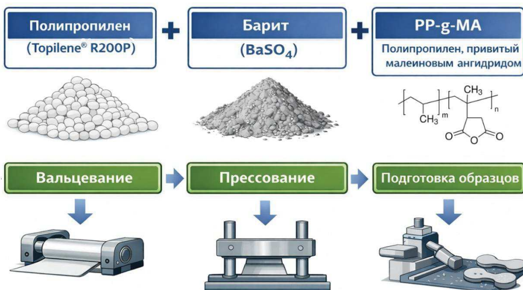
Рисунок – Блок-схема основных этапов получения композитных материалов
