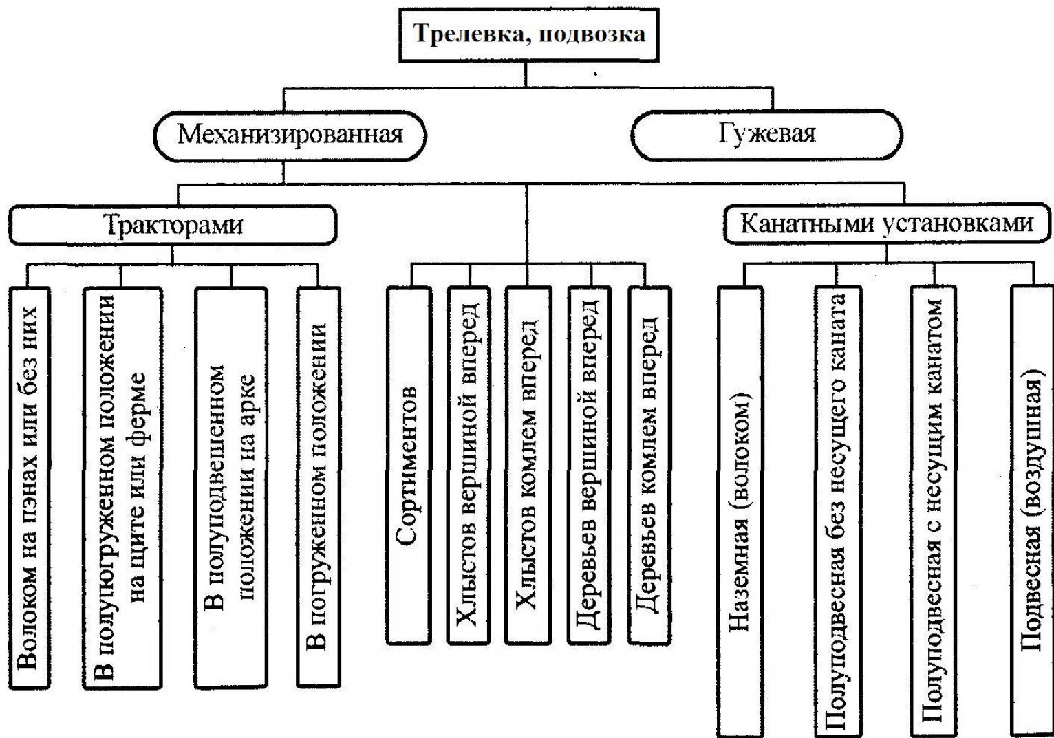
Рис. 11.1 – Способы трелевки и подвозки древесины
