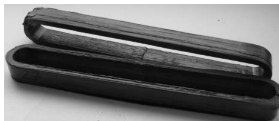
Рис. 4. Макеты овальных намотанных изделий
